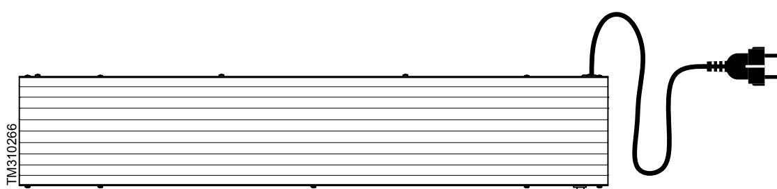
Конструкция воздушно-тепловой завесы «Микро» состоит из одного вентиляторного блока.
