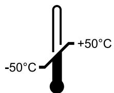
**!** После транспортирования в условиях отрицательных температур, следует выдержать изделие в помещении, где предполагается его эксплуатация, без включения в сеть не менее 2-х часов
