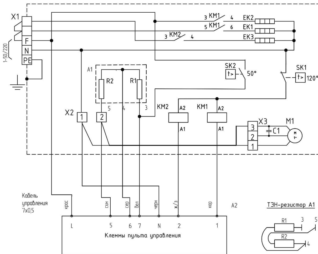
Рисунок 8-Электрическая схема завесы КЭВ-6П3031Е, КЭВ-9П3031Е
