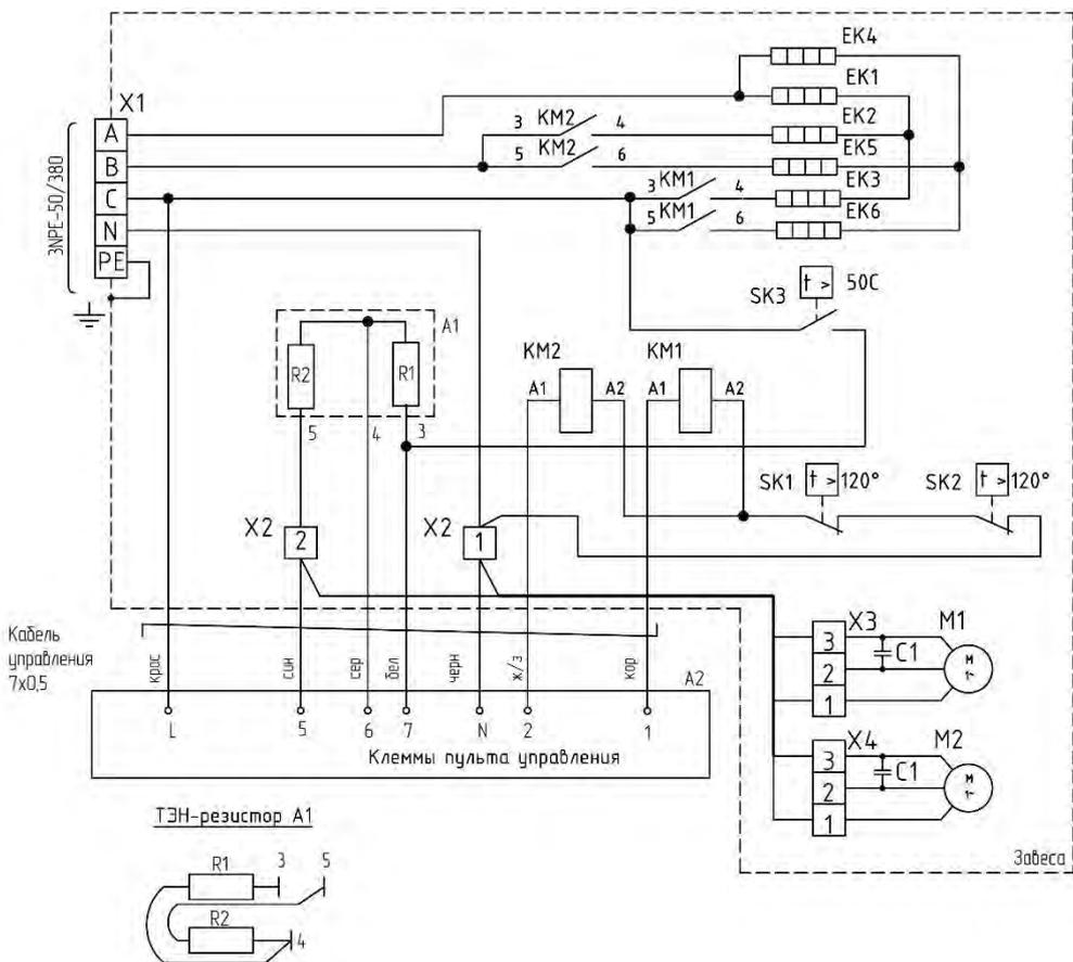
Рисунок 12-Электрическая схема завесы КЭВ-24П3041Е
