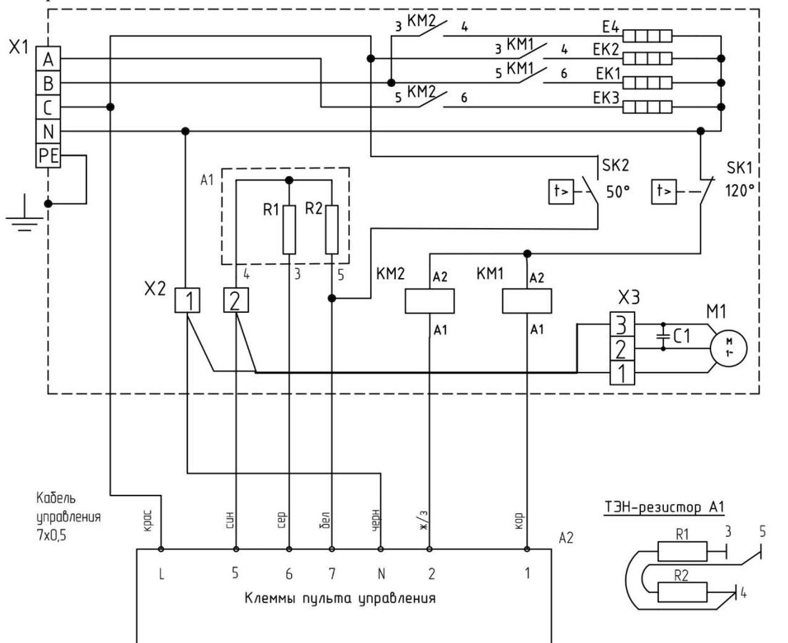
Рисунок 10-Электрическая схема завесы КЭВ-9;12;15П3011Е
