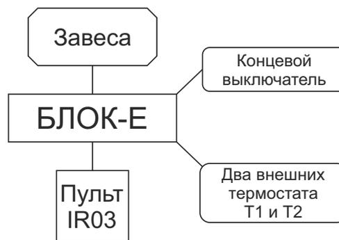
4.8.2 Элементы автоматического регулирования (концевые выключатели и внешние термостаты Т1 и Т2) должны быть предусмотрены в проекте и установлены монтажной организацией (в комплект поставок могут быть включены по специальному заказу)
