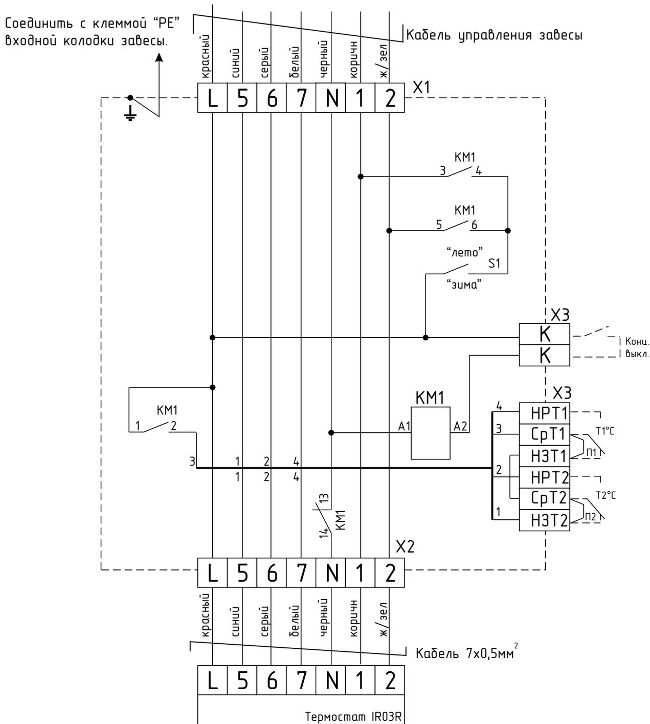
Рисунок 11. Электрическая схема пульта коммутации и управления для завес с электрическим источником тепла «ПКУ-Е»
