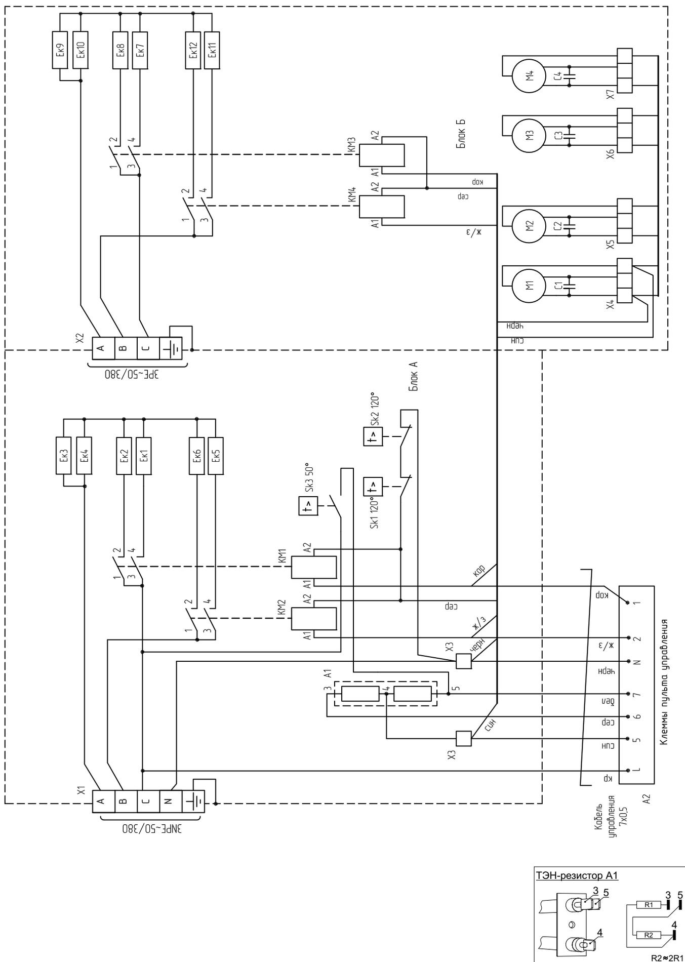
Рисунок 9. Электрическая схема завес КЭВ-36;45П5031Е, КЭВ-54П5041Е.
