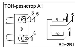
Рисунок 7. Электрическая схема завесы КЭВ-24П5031Е
