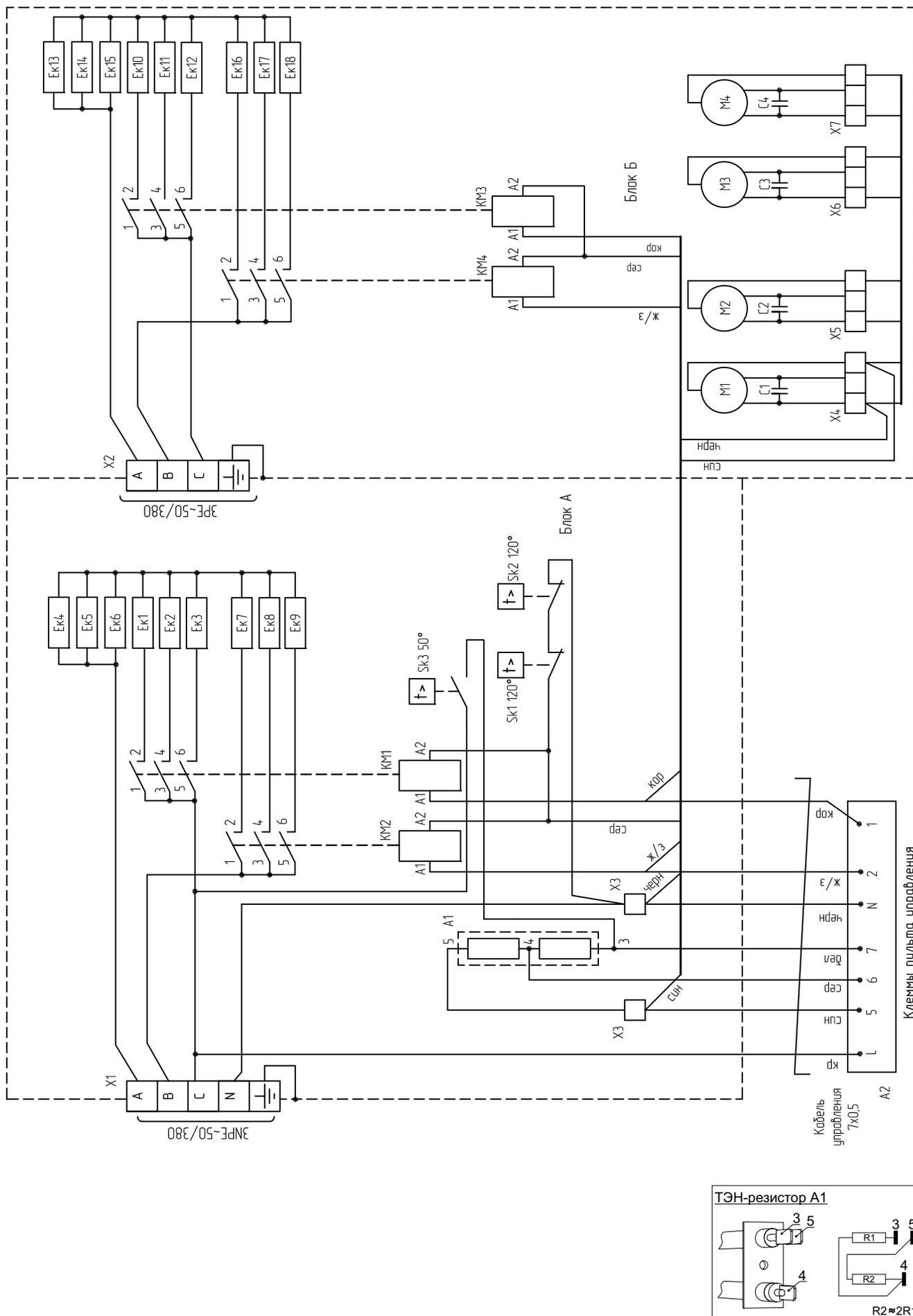
Рисунок 10. Электрическая схема блока подключения концевого выключателя к завесам с электрическим источником тепла «БЛОК-Е»
