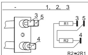
Рисунок 6. Электрическая схема завесы КЭВ-48П7021Е
