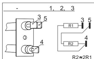
Рисунок 4. Электрическая схема завесы КЭВ-42П7011Е
