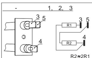
Рисунок 6. Электрическая схема завесы КЭВ-48П7021Е
