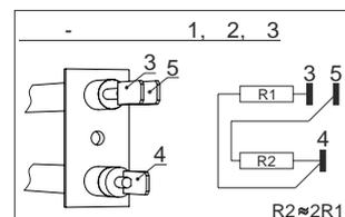
Рисунок 7. Электрическая схема завесы КЭВ-60П7021Е
