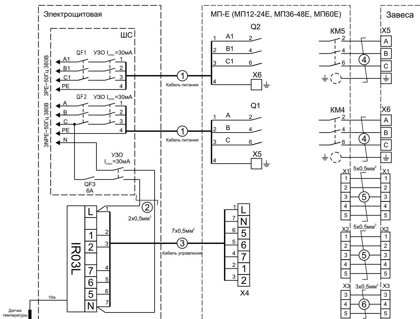
Рисунок 2. Схема подключения группы от двух до двадцати влагозащищенных завес к одному пульту управления IR03L
