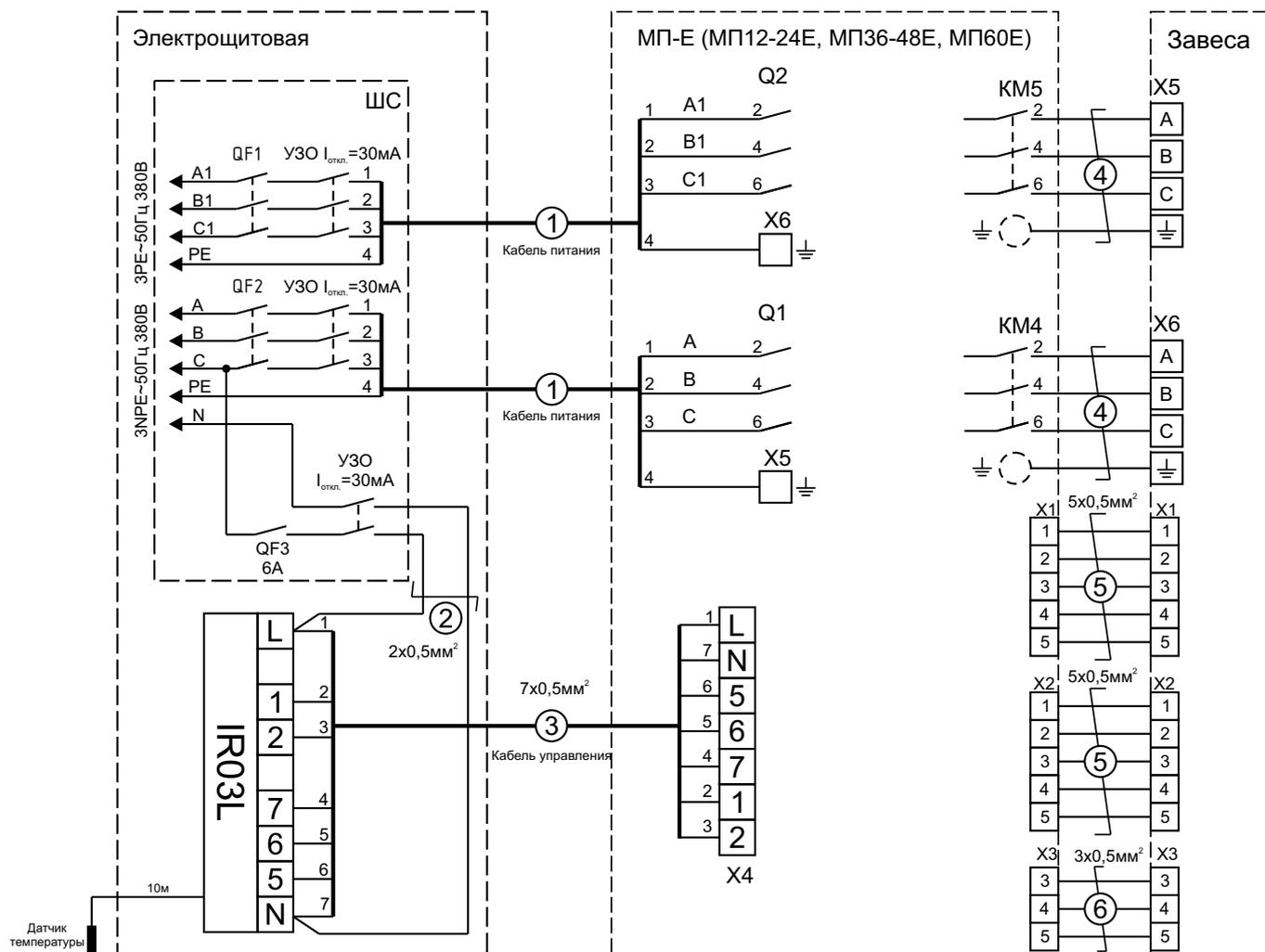
Рисунок 2. Схема подключения группы от двух до двадцати влагозащищенных завес к одному пульту управления IR03L
